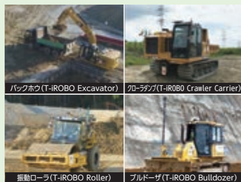
① 無人化施工技術：T-iROBO®シリーズを引用
