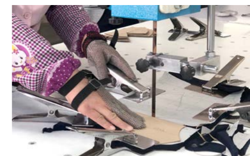
バンドナイフ作業時における安全対策(中国、仕入先製造委託先工場)
