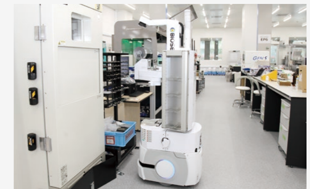
各自動化装置間を連携するモバイルロボット
