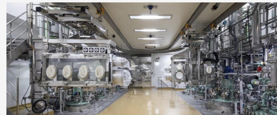
封じ込めレベル0.05 \mu\text{g}/\text{m}^3 以下のアイソレーター
