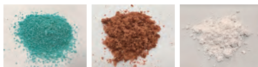
回収物(左から硫酸ニッケル、硫酸コバルト、炭酸リチウム)
