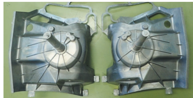
当社独自技術HIGF法で生産した車体系部品(ショックタワー) 2個/1射出
