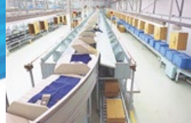
リアモータ駆動の自動仕分け装置・リニソート(1992年)
