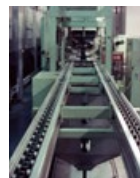
フリーフローコンベヤ用に開発したブラサイドローラ付チェーン（1981年）
