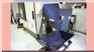
工作機械の金属屑搬送 チップコンベヤ
