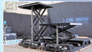
舞台の昇降装置 ジップチェーンリフタ
