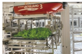
植物工場でレタスを自動搬送するオートランパングード(2021年)
