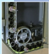
工作機械 ATCチェーン、パワーロック
