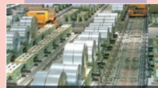
コイルストックヤード コイルロボシステム
