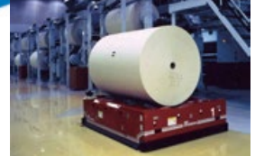
新聞巻取紙搬送の自動化、作業改善に貢献する給紙AGV(1996年)
