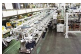
国内外の家電メーカーで採用されたブラウン管塗布工程システム（1982年）
