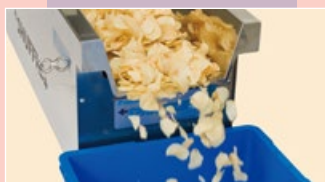
金属加工・食品工場 シャッフルコンベヤ
