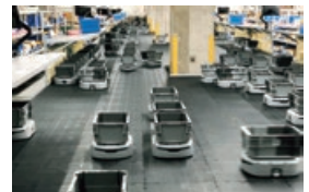
小型AGVによる搬送仕分けシステムT-Carry system(2020年)
