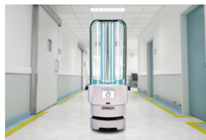
消毒作業時の感染拡大防止につながる紫外線照射器ロボット
