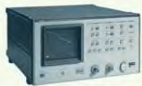
光通信向け測定器 (世界初の光パルス試験器 OTDR) を開発
