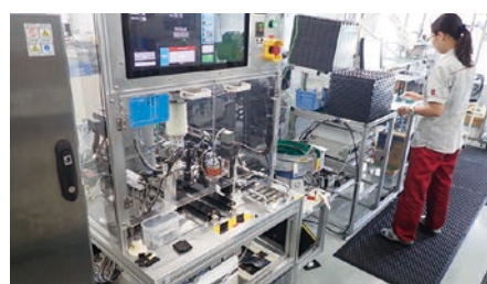
MEMSセンサの自動組立工程
