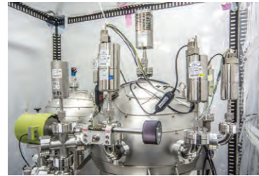
高い精度を誇る真空校正装置
