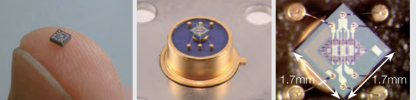
独自開発の気体流量計 MEMSセンサ(マイクロフローセンサ™) (センサのサイズ: 1.7mm×1.7mm×0.5mm)
