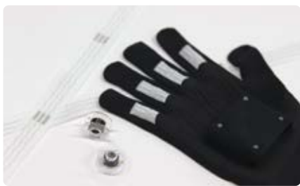
介護・福祉分野での活用が期待されるカーボンナノチューブを利用したウェアラブルセンサー
