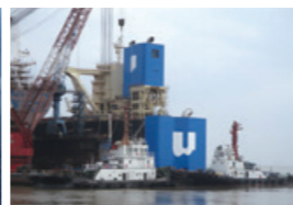
既存船へのSOxスクラバー搭載
