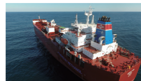
メタノール二元燃料主機関搭載船「CREOLE SUN」
