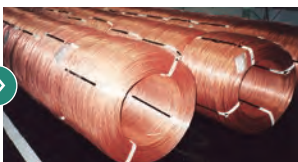
再生された電線
