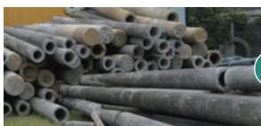
再生処理前のコンクリート柱
